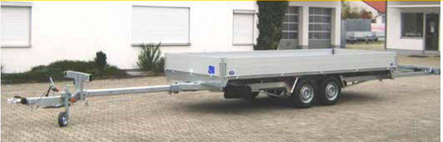
Abb: UE 35 52 20 zul. GG 3.500 kg , Brückenmaße 5.200 x 2.050 mm, Sonderausstattungen: Längenverstellbare Deichsel ca. 1.800 - 3.550 mm, abnehmbarer Material-Auflagebock auf der Deichsel (Anhänger-Ladefläche mit LV-Deichsel mind. 4.000 mm) Kunststoffstaukasten 550 x 250 x 290 mm unter der Brücke
