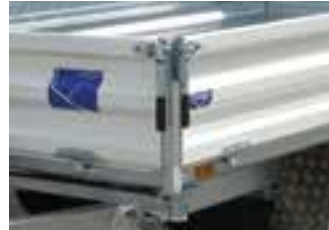
Sonderausstattung: Pendelverschlüsse 664 an Stahlbordwand, verzinkt u. lackiert
