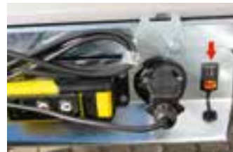
C-Tek-Lade-Steckdose mit Batterie-Ladestandsanzeige (voll / halb / leer)
