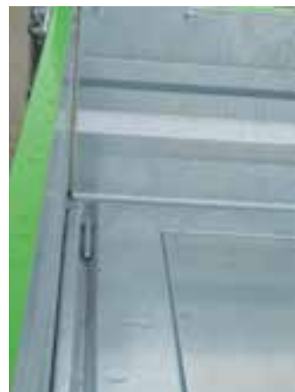
Sonderausstattung: Zusatzboden aus 2 mm Stahlblech verzinkt (auf Holzboden geklebt, geschraubt, versiegelt)
