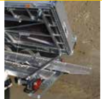
Serien-Detail: Rampenschacht unter der Brücke mit Klapp-Unterfahrerschutz
