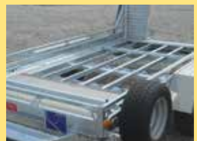
Serien-Detail: Längs-Unterzüge für hohe Punktlasten
