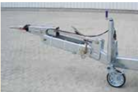
Sonderausstattung: Höhenverstellbare Zugeinrichtung (Entfall der Baggerschaufelablage)
