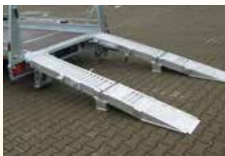
Sonderausstattung: ALTEC-ALU-Rampen verlängert, klapp- und faltbar (L x B ca. 2.410 x 310 mm) mit Stützböcken
