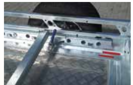
Sonderausstattung: ALU-Boden, Maschinenanschlagsschiene verstellbar, Ersatzrad seitlich an der Reling
