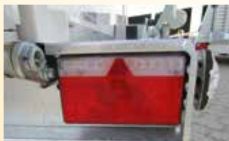
Sonderausstattung: LED-Beleuchtung geschützt im Unterfahrerschutz
