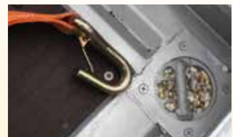
Sonderausstattung: Drehbarer Zurrstab - 1.250 daN (nur in den Ecken möglich)
