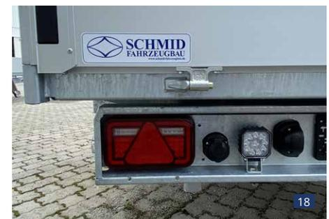
LED-Beleuchtung, Zusatz-Rückfahr-Scheinwerfer, Steckdose für Zusatz-Lichtbalken oder Ladungs-sicherungsleuchte 18
