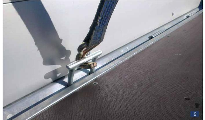
Hochziehbare Zurrbügel in Bodenrahmen-Längssicke versenkt eingebaut 9
