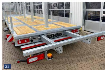
Heckauszug rollengelagert, max. 1,5 m ausziehbar, max. 2 t belastbar, Zusatzbeleuchtung Warnpaket Überbreite
