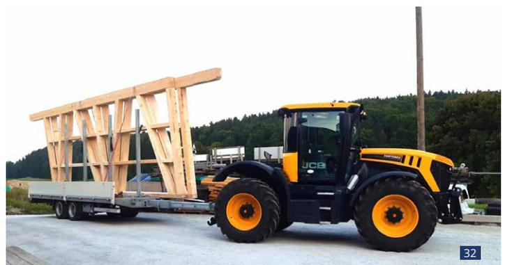
Abb. 31 und 32: Serien-Bordwandaufbau 500 mm ALU, mit abgenommener Stirnwand
