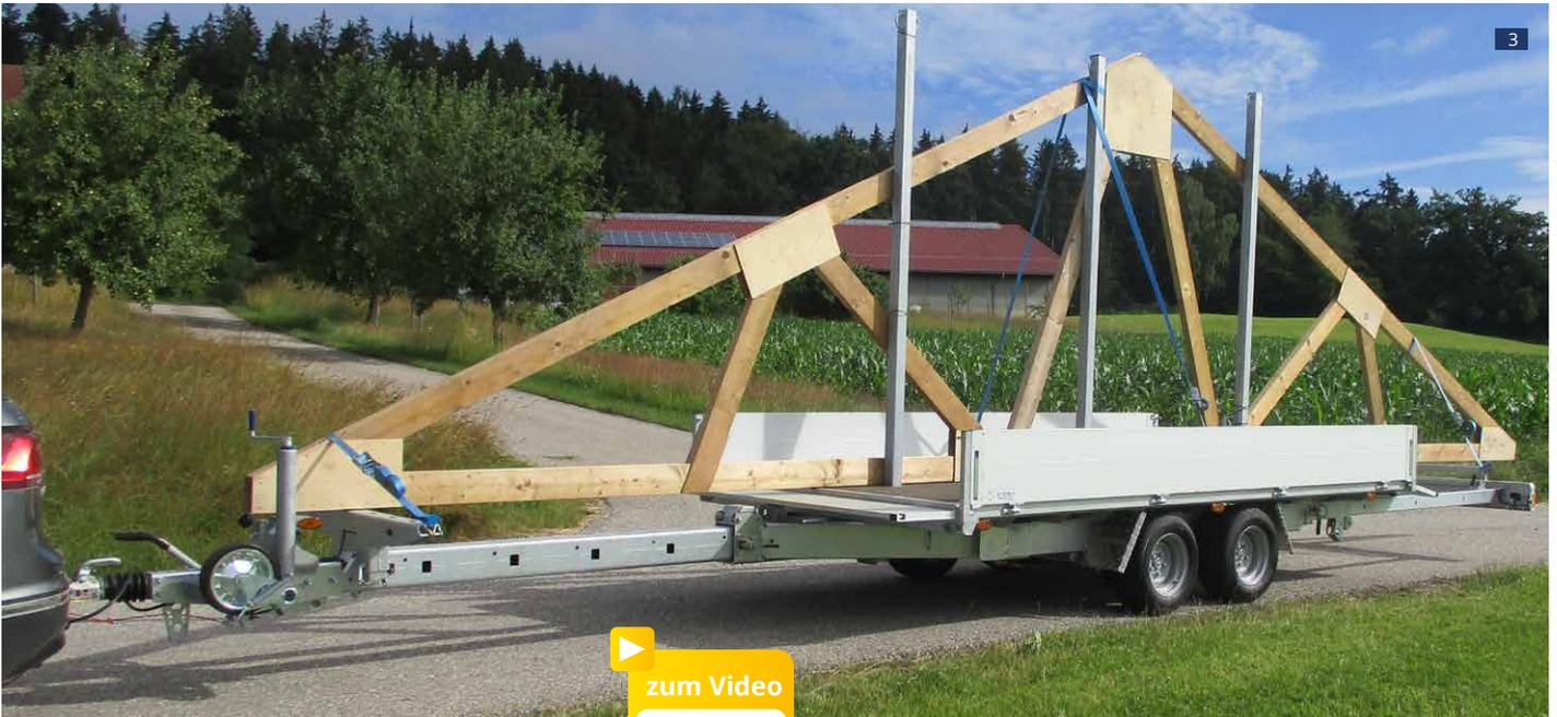
Stirnwand abklappbar und abnehmbar, Materialauflagebock vorne steckbar und höhenverstellbar
