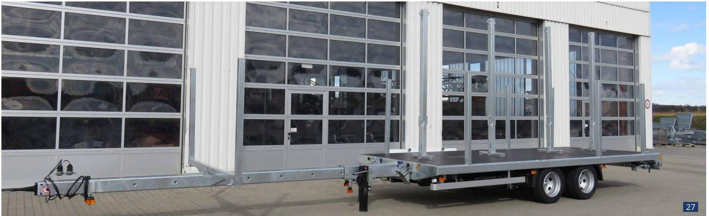
Deichsel ausgezogen 5.500 mm mit steckbarem Materialauflagebock und steckbaren Außenrungen
