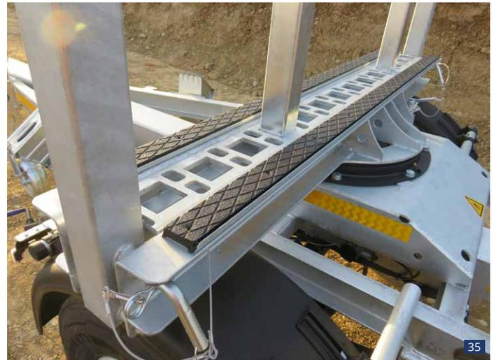
Abb. 34 und 35: 2 Klapprungen außen mit Spannkette, dazu 2 Zusatzsteckerungen breitenverstellbar in Kombination mit Zurrchiene
