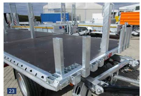
Rungentaschen-Kassette 100 x 50 mm, Parkhalterung für Rungen stirnseitig, (ersetzt ggf. zugleich die Stirnwand), Abb.: Siebdruckbodenplatte
