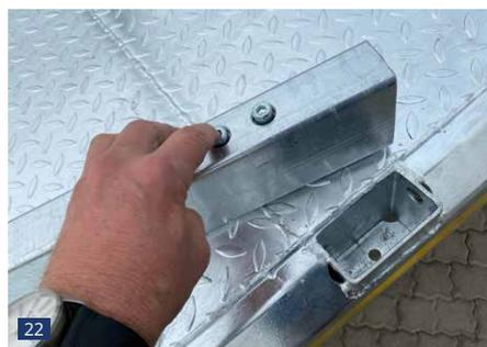
Außenrungen 100 x 50 mm, mit Eindrückzapfen = Herausfallsicherung, verzinkter Tränenblechboden
