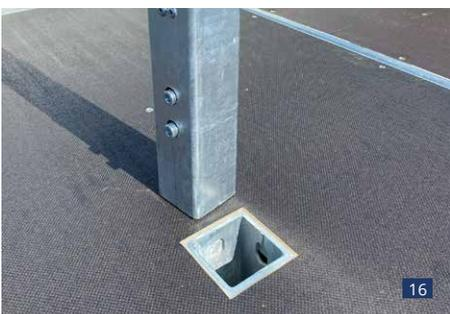
Abb. 16 und 17: Bodentaschen und steckbare Säulen 70x70 mm mit Herausfallsicherung in der Ladefläche und/oder seitlich außen im Bodenrahmen.
