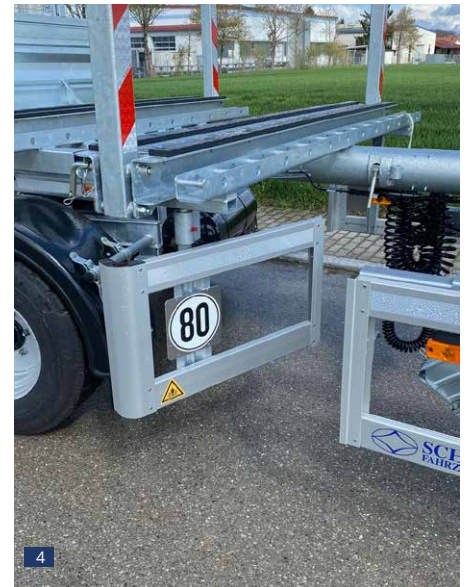
Abb. 4: Seiten-Unterfahrerschutz mit Bediener-Zugang (Tür-Öffnung)
