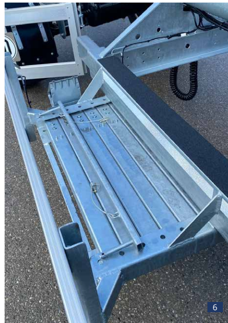
Abb. 6: Parkhalterung / Depot für die 6 Stück Zusatz-Steckerungen
