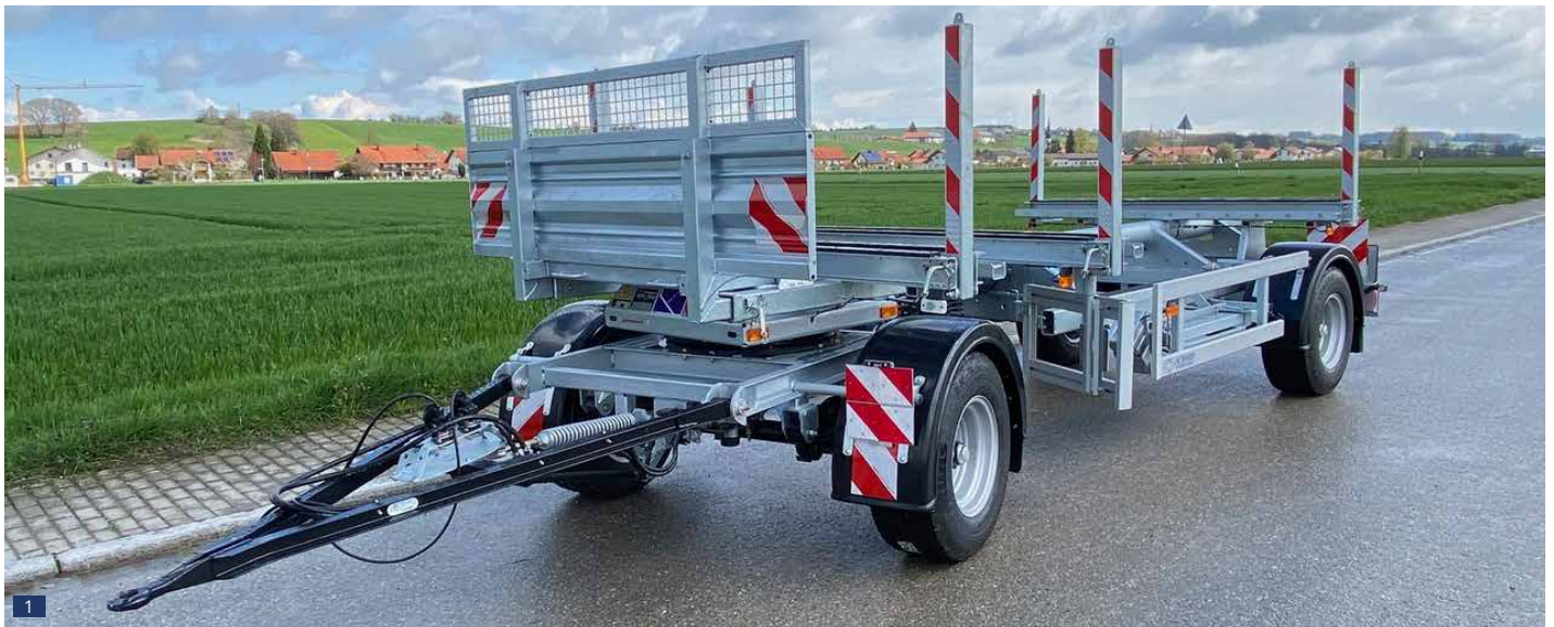
Abb. 1: In kürzester Radstand-Stellung (4.300 mm) = Leerfahrt-Stellung Sonderausstattungen: Breitreifung, Warnpaket für Überlänge, längenverstellbare Stirnwand (770 – 1520 mm)
