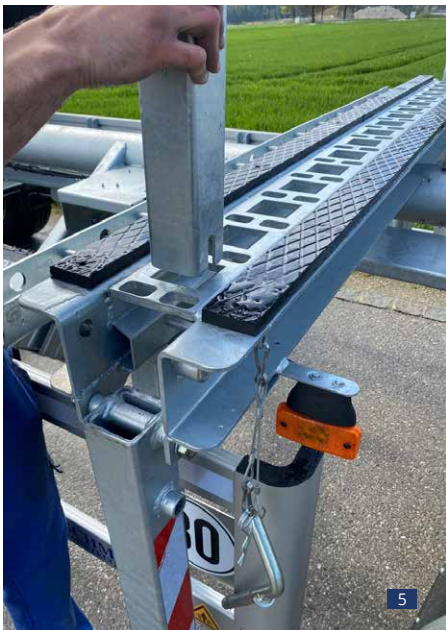
Abb. 5: Ladeschemel mit Gummi-Auflage, Spezial-Zurrschiene für Spannmittel und Zusatz-Steckerungen für optimierte Ladungssicherung
