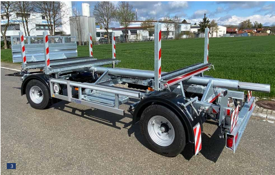
Abb. 3: In kürzester Radstand-Stellung (4.300 mm)
