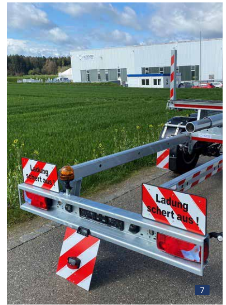
Abb. 7: Heckauszug leichtgängig rollengelagert bis max. 2 m - in Verbindung mit Ausnahmegenehmig. §70 StVZO - in Verbindung mit Warnpaket für Überlänge
