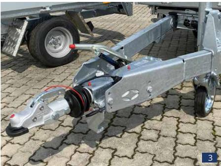
Serien-Detail: Einbindung der Zugeinrichtung (Auflaufeinrichtung) in V-Deichsel - höhenverstellbar
