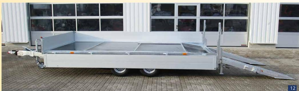
Sonderausstattungen: Anhänger Ladefläche heckseitig abgeschrägt, Rampen fest angebaut - klappbar, ALTEC-ALU-Rampen L x B 1970 x 400 mm mit klappbarem Abstützbock, nur in Verbindung mit Bereifung 225 / 55 R 12 LH ca. 670 mm
