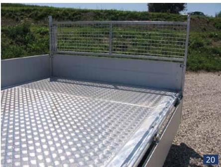
Sonderausstattung: ALU-Tränenblechboden auf Siebdruckboden, Stirnwanderhöhung / Lastenschutzgitter verzinkt
