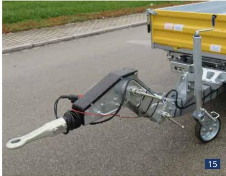
Sonderausstattung: Höhenverstellbare Zugdeichsel (Wechsel zwischen Kugel und 40er DIN-Öse möglich) 70er Stützrad verstärkt
