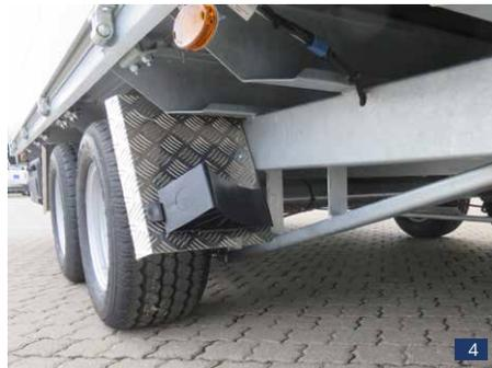
Serien-Detail: Hauptrahmen – Unterzug für lange Brücken > 4.500 mm, bei Sonderausstattung längenverstellbare Deichsel für lange Brücken > 6.000 mm
