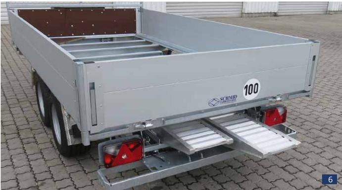
Sonderausstattungen: Rampenpaket mit Rampenschacht hinter klappbarem Unterfahrschutz, ALTEC-ALU-Einschubrampen 2,8 t / Paar, L x B 2410 x 310 mm, klappbare Heckstützen, Bereifung 225 / 55 R 12 - LH ca 670 mm, 100 km/h-Ausführung
