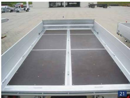
Sonderausstattungen: Mittel-Zugschiene mit hochziehbaren Zurrbügeln, Bodenrahmen vorne und hinten mit Sicke und Zurrbügel
