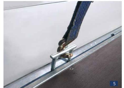
Serien-Detail: Hochziehbarer Zurrbügel (800 daN) in V-Sicke
