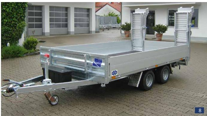
Sonderausstattungen: Stirnwand verstärkt aus Stahl verzinkt, ALTEC-ALU-Klapp-Faltrampen L x B ca. 2410 x 310 mm, Staubox in der V-Deichsel, Stützrad vollautomatisch, Bereifung 225 / 55 R 12 - LH ca. 670 mm
