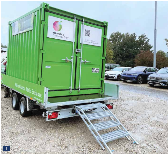
1 Leicht ausziehbare Falt-Auszugstreppe , 800 mm breit, mit rutschfesten Stufen, unter der Ladefläche einschiebbar
