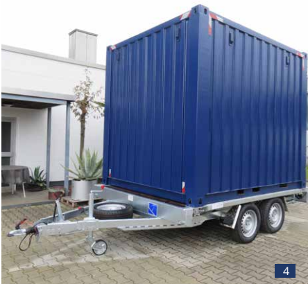
Abb. 4 - 6: UE 27 33 24 - zul GG. 2.700 kg, Plateau 3,30 x 2,45 m - mit Container
