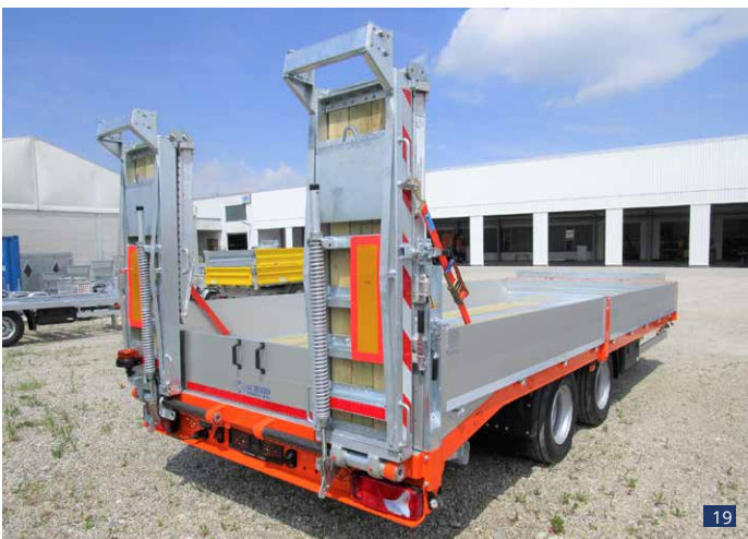
Abb. 18: Luftfederung mit Heben & Senken zum Absenken der Ladefläche und zur Minimierung der Auffahrwinkel. EBS-Bremsanlage + Federspeicher-Feststellbremse
