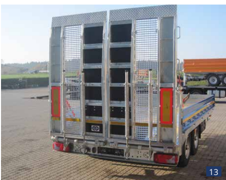
Abb.. 11: Heck abgeschrägt, 1-teil. Rampe 2,30 m lang, Breite 930 mm, doppelter Gitterrostbelag, doppelte Federheber
