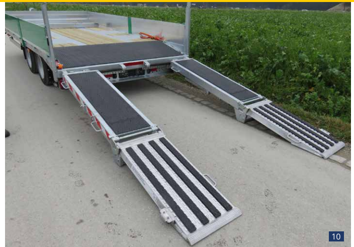
Abb. 10: Heck abgeschrägt, 2-teil. Rampe 3,0 m lang, mit Stahl-Gummi-Belag auf Rampe und Heckschräge
