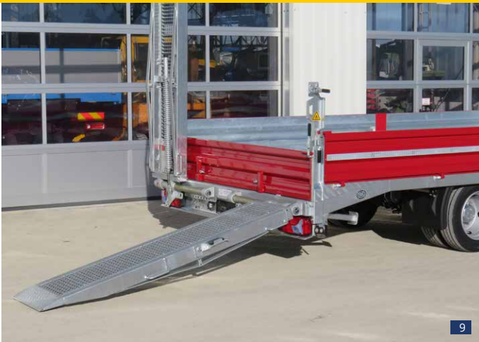
Abb. 9: Heck abgeschrägt, 1-teil. Rampe 2,30 m lang, mit Gitterrostbelag
