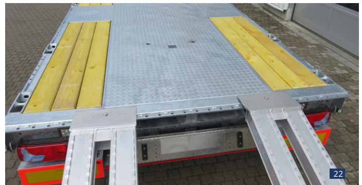
Abb. 22: 8,7 t ALU-Anlegerampen (dt. Fabr. ALTEC) mit Lochleiste als Abrutschsicherung - in der Breite verstellbar. Abb. mit Serien-Holzdielenboden. Je nach Konstruktion kann der Boden oberhalb des Rampenschacht auch als verzinkter Blechboden ausgeführt sein - für niedrigere Ladehöhe bzw. Auffahrwinkel
