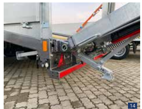
Abb. 12: Heck abgeschrägt, 1-teil. Rampe 2,3 m lang, Breite 730 mm, Gitterrostbelag und Stahl-Gummi-Belag, doppelte Federheber, autom. Klappstützen
