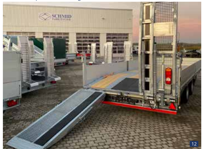
Abb. 12: Heck abgeschrägt, 1-teil. Rampe 2,3 m lang, Breite 730 mm, Gitterrostbelag und Stahl-Gummi-Belag, doppelte Federheber, autom. Klappstützen
