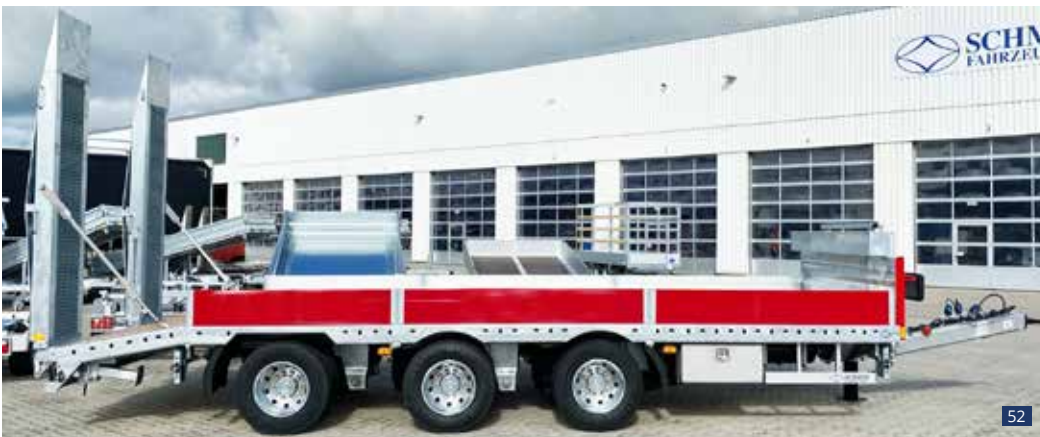
Abb. 52: TDUE 280 ZSR zul. GG 28.000 kg Achsabstand 1,31 m + 1,41 m Nachlauf-Lenkachse, Liftachse
