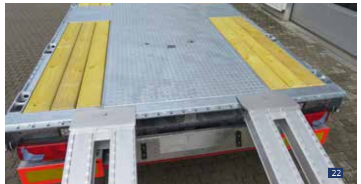
Abb. 22: 8,7 to. ALU-Anlegerampen (dt. Fabr. ALTEC) mit Lochleiste als Abrutschsicherung - in der Breite verstellbar. Abb. mit Serien-Holzdielenboden. Je nach Konstruktion kann der Boden oberhalb des Rampenschacht auch als verzinkter Blechboden ausgeführt sein - für niedrigere Ladehöhe bzw. Auffahrwinkel
