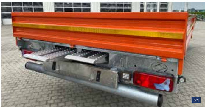
Abb. 21: Serien-Rampenschacht mit Deckel abschließbar
