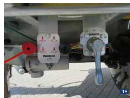
Abb. 18: Luftfederung mit Heben & Senken zum Absenken der Ladefläche und zur Minimierung der Auffahrwinkel. EBS-Bremsanlage + Federspeicher-Feststellbremse
