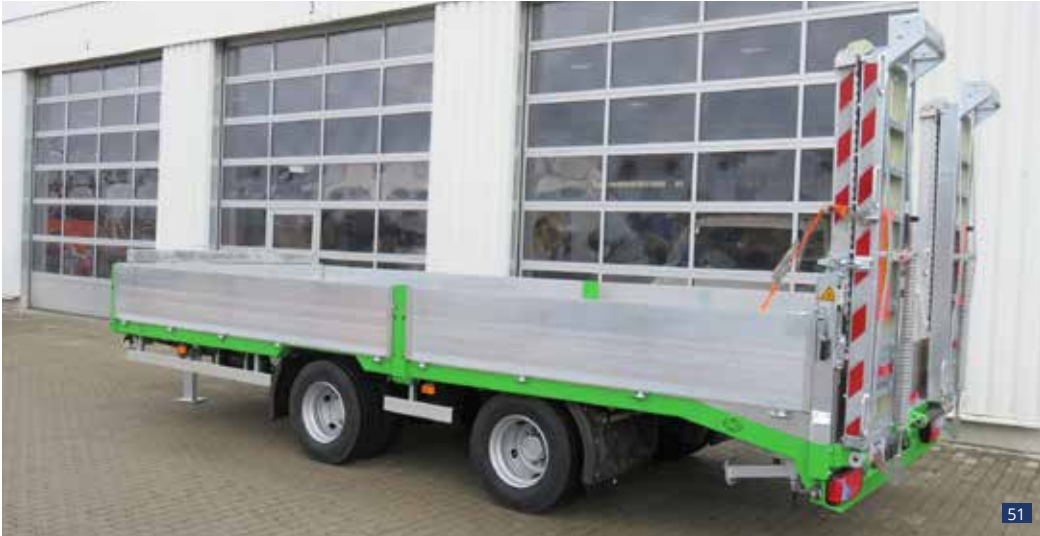
Abb. 51: TUE 210 ZSR zul. GG 21.000 kg Achsabstand 1,81 m, mit Lenkachse
