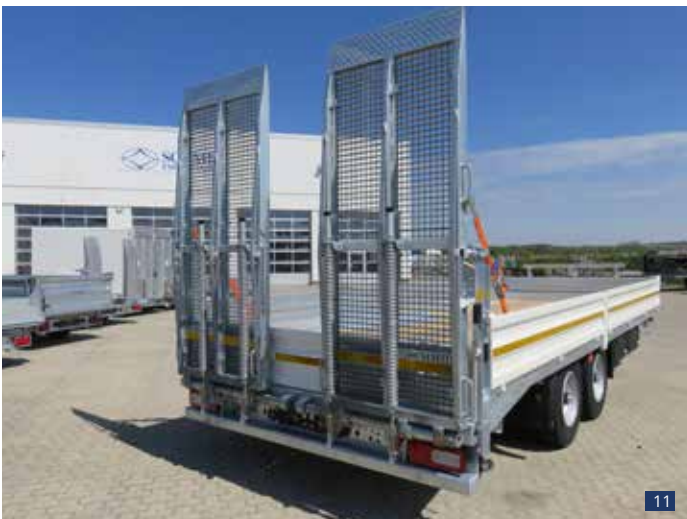
Abb. 11: Heck abgeschrägt, 1-teil. Rampe 2,30 m lang, Breite 930 mm, doppelter Gitterrostbelag, doppelte Federheber
