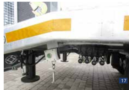
Abb. 17: Steuerventile für 2 x hydr. Rampenheber, 2 x hydr. Heckstützen, dazu Tastschalter zum Starten für optionales elektr. hydr. Pumpenaggregat
