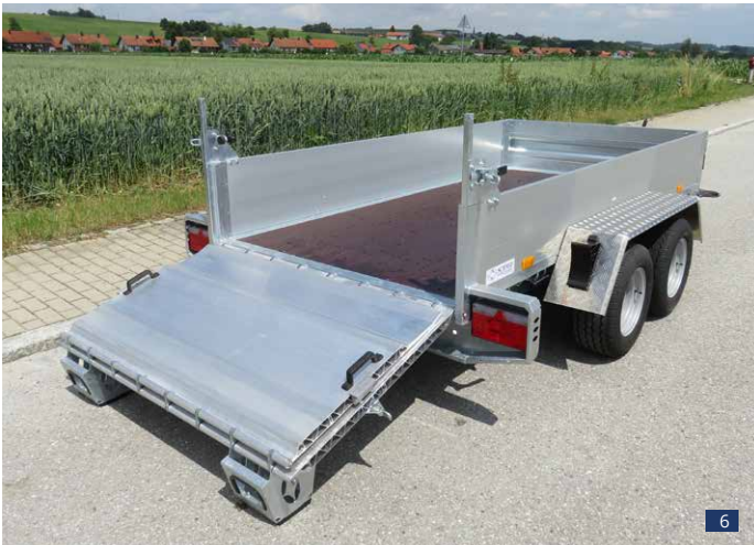
Abb. 6 - 7: PVT 30 KFR, zul. GG 3.000 kg – Serienbrücke 3,00 x 1,50 m, Serienräder 225/55 R 12 – Serien-Ladehöhe LH ca. 480 mm Sonderausstattungen: ALU-Bordwände silber eloxiert anstelle Stahlwände verzinkt, LED-Beleuchtung
