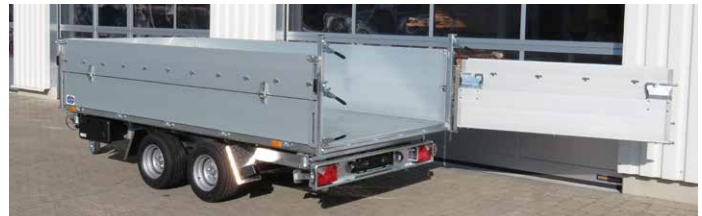
Sonderausstattung: Heckwand schwenkbar und an Seitenwand arretierbar, Aufsatzbordwand 350 mm mit Netzhaken
