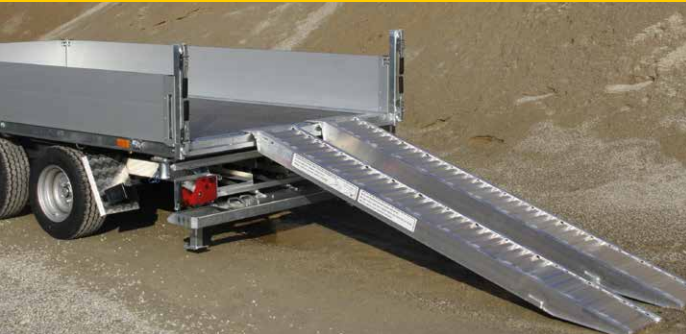
Sonderausstattung: ALTEC-ALU-Anlegerampen, Tragkraft 2,8 t / Paar, L x B ca. 2.410 x 310 mm
