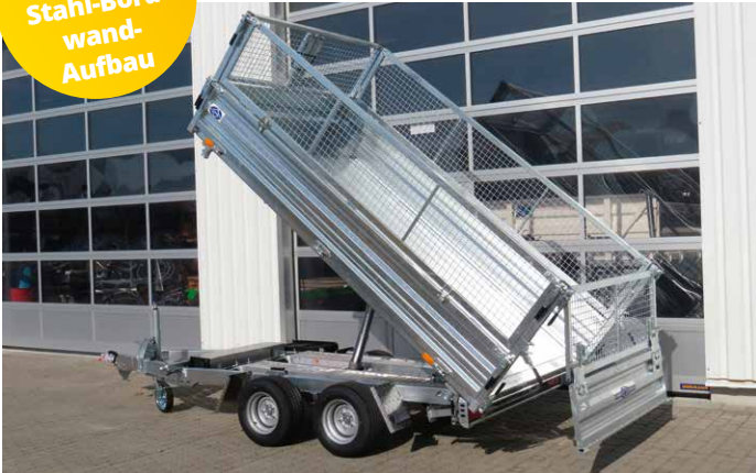
Abb: PDK 35-12 K zul. GG. 3.500 kg, Serien-Brücke 3,20 x 1,75 m
