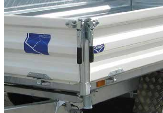
Sonderausstattung: Pendelverschlüsse 664 an Stahlbordwand, verzinkt u. lackiert
