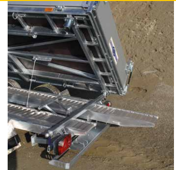
Serien-Detail: Rampenschacht unter der Brücke mit Klapp-Unterfahrerschutz
