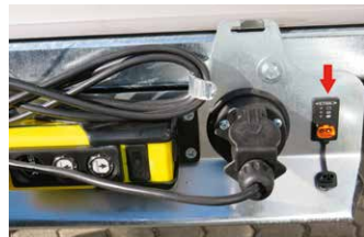
C-Tek-Lade-Steckdose mit Batterie-Ladestandsanzeige (voll / halb / leer)
