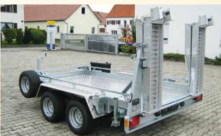
Sonderausstattung: Staubox seitlich rechts, Ersatzrad seitlich links, Rampen verlängert klapp- und faltbar (ca. 2410 x 310 mm) Abstellstützen hinten abklappbar und kurbelbar, Zusatzboden ALU-Tränenblech
