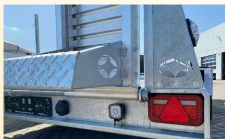
Sonderausstattung: LED-Beleuchtung geschützt im Unterfahrerschutz
