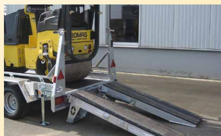
Sonderausstattung: Rampenbelag zusätzlich aus Gummi - rutschhemmend (z.B. für Walze)
