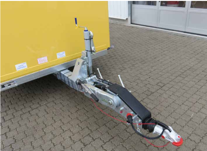
Sonderausstattungen: Höhenverstellbare Zugdeichsel mit Kugelkupplung (wechselweise 40 mm DIN-Zugöse), mit verstärktem 70er Stützrad, Aufbau lackiert in RAL nach Wunsch
