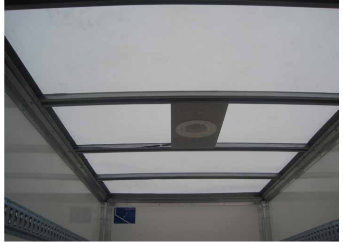
Serien-Detail: Lichtdurchlässiges Aufbaudach Sonderausstattung: Deckenleuchte (Schalter am Heck)
