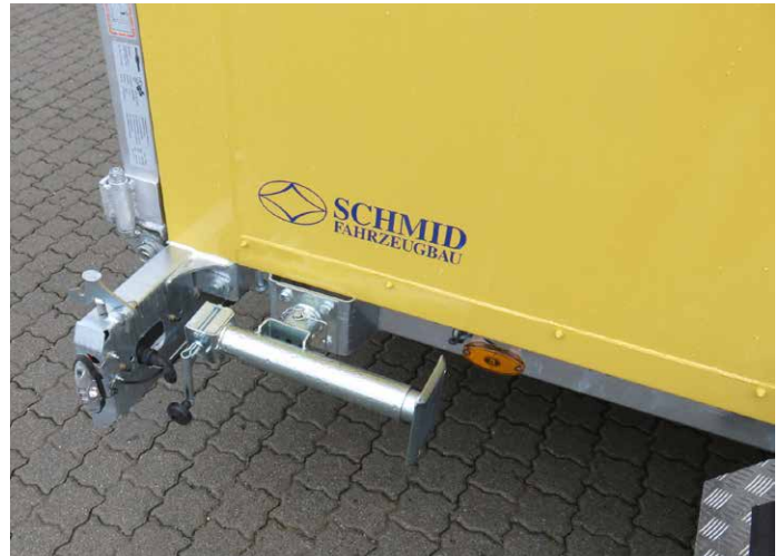
Serien-Detail: Schwenkbare Kurbelstütze Sonderausstattung: Aufbau lackiert in RAL nach Wunsch
