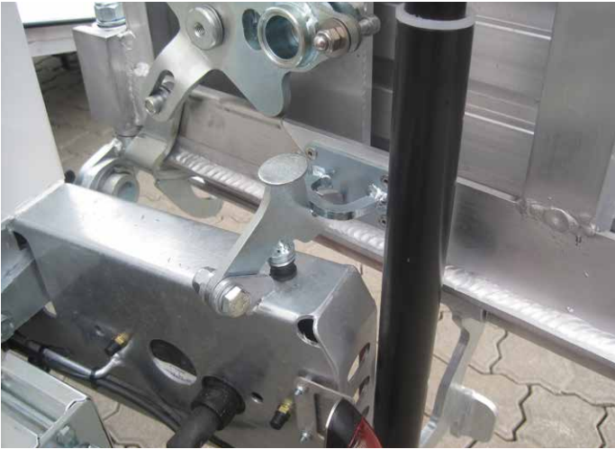
Serien-Detail: Türfestseller und Gasdruckfeder als Hubhilfe
