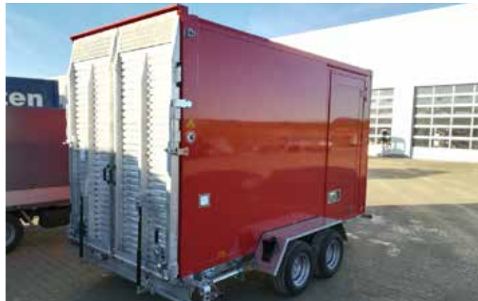
Sonderausstattung Bild links: Wendekabel 15 pol. 24 Volt und 13 pol. 12V nur in Verbindung mit LED-Rückleuchte Sonderausstattung Bild Mitte: Aufbau lackiert in RAL nach Wunsch, Kiemlüfter seitlich hinten und vorne (nicht sichtbar)
