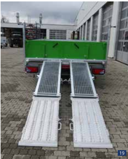
Abb. 17 - 19 (oben und links): Serien-Faltrampen mit Federheber Basisteil mit Gitterrost Falteil kpl. ALU (ALTEC) Sonderausstattung: Parkhalterung der ALU-Heckwand auf der Stirnwand
