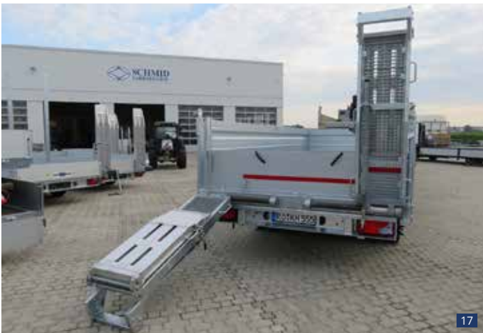
Abb. 17 - 19 (oben und links): Serien-Faltrampen mit Federheber Basisteil mit Gitterrost Falteil kpl. ALU (ALTEC) Sonderausstattung: Parkhalterung der ALU-Heckwand auf der Stirnwand
