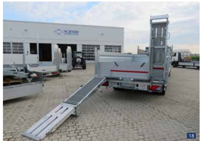
Abb. 17 - 19 (oben und links): Serien-Faltrampen mit Federheber Basisteil mit Gitterrost Falteil kpl. ALU (ALTEC) Sonderausstattung: Parkhalterung der ALU-Heckwand auf der Stirnwand
