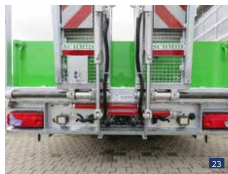
Abb. 22 - 23: Sonderausstattung: Rampen hydr. betätigt und hydr. Seitenverschiebung, dazu Steuerventile unter der Brücke in Fahrtrichtung rechts hinten
